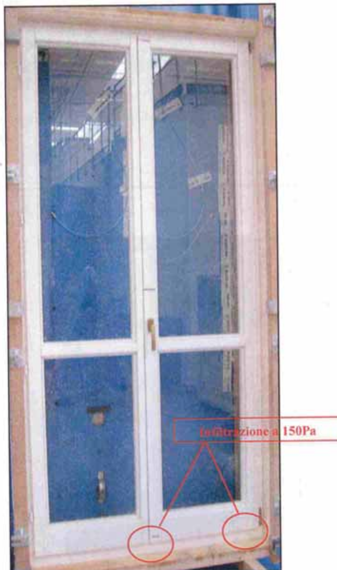
Figura 1 - Fotografie del campione in prova: localizzazione dell'area dell'infiltrazione
